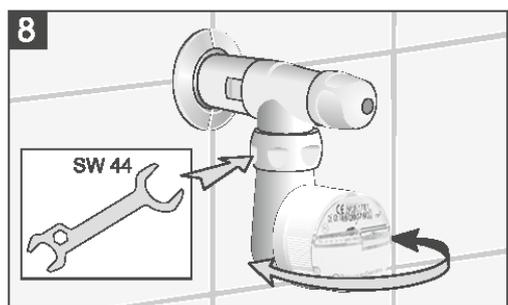
Zähler ausrichten und festziehen, Kontrolle Festsitz!
