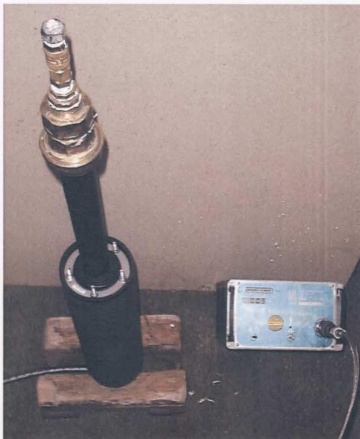
Bild 2: Prüfung der Ringraumdichtung mit eingestecktem Polyethylenrohr
