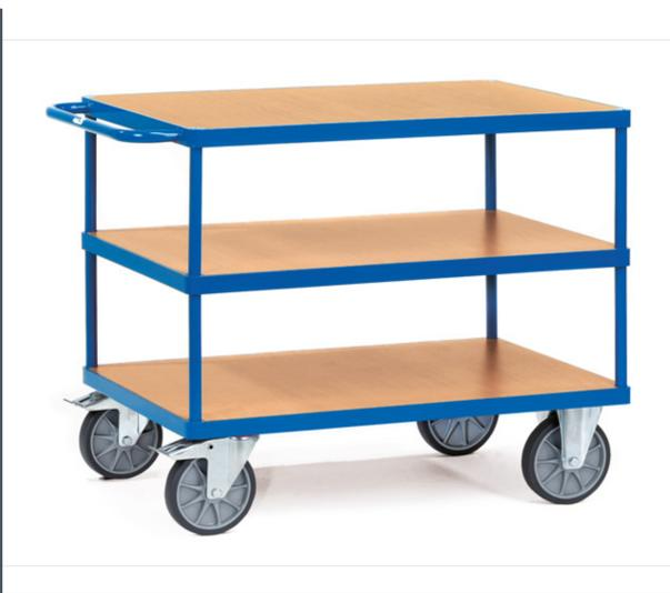
Stahlrohr und Profilstahl geschweißt, pulverbeschichtet RAL 5007. 3 Plattformen aus Holzwerkstoffplatte, Oberfläche Buchendekor. 2 Lenk- und 2 Bockrollen, TPE-Bereifung, Naben mit Rillenkugellager. Feststeller an den Lenkrollen, gemäß der Europäischen Norm EN 1757-3 (Sicherheit von Plattformwagen). Tragkraft obere und mittlere Ladefläche 200 kg.
