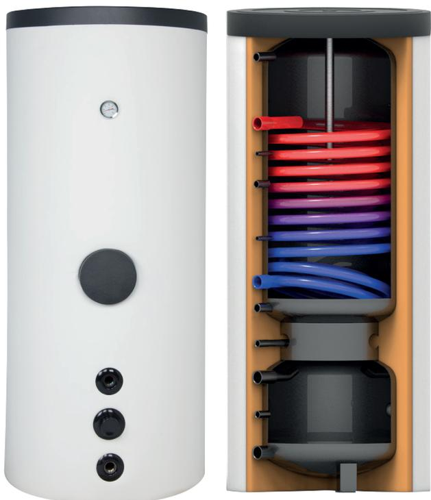
Indirekt beheizter Warmwasser-Standspeicher mit einem Hochleistungswärmetauscher und integrierte Pufferspeicher. Besonders geeignet in Verbindung mit einer Wärmepumpe oder Brennwert-Wärmeerzeuger, um ein Takten des Wärmeerzeugers zu vermeiden.
