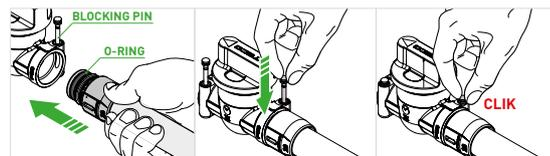
**FASTEC®** System mit ein einfacher Fingerdruck, erlaubt eine schnelle Verbindung der **Verlängerung/Verbinder**, ohne die Verwendung **irgend Art von Geräten**.
