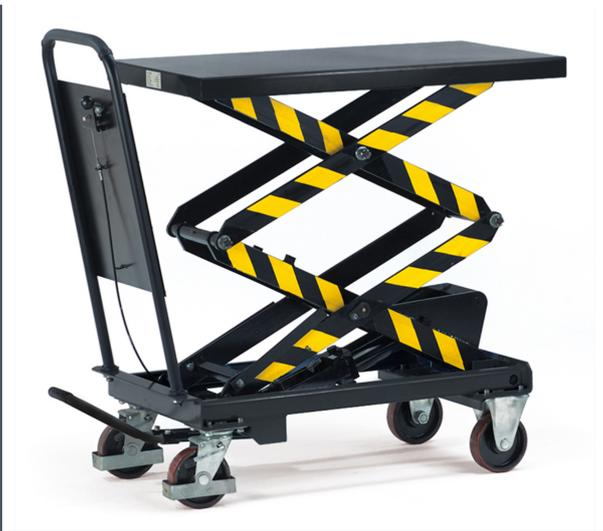
Hubtischwagen aus Profilstahl-/Stahlblech-Konstruktion, pulverbeschichtet anthrazitgrau RAL 7016. Kräftiger Rohrschiebebügel. Hydraulikpumpe mit verchromten Kolben. Betätigung über Fußpedal. Senkventil über Handhebel feinfühlig zu betätigen. Plattform 50 mm hoch. Doppelschere für besonders großen Hubbereich. 2 Lenk- und 2 Bockrollen, Räder Polyurethan-Bereifung, Lenkrollen mit Feststeller. 2 Jahre Garantie
