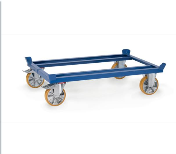
Für Flachpaletten und Gitterboxen. Robuste Winkelstahl-Schweißkonstruktion, mit 4 Fangecken, pulverbeschichtet, blau RAL 5007. 2 Lenk- und 2 Bockrollen, Polyurethan-Bereifung, Naben mit Kugellager, Feststeller an den Lenkrollen, gemäß der europäischen Norm EN 1757-3 (Sicherheit von Plattformwagen). Geringer Rollwiderstand, elastischer Lauf, keine Fahrgeräusche.
