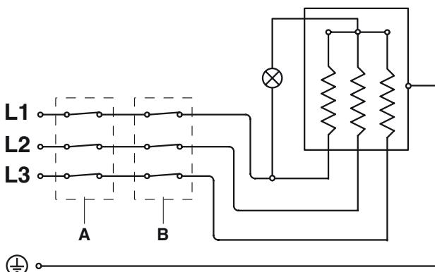
A: Contacts thermostat de sécurité ( $98^{\circ}\text{C}$ )
