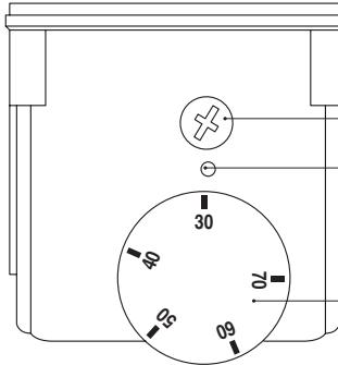
Bouchon du thermostat de sécurité
