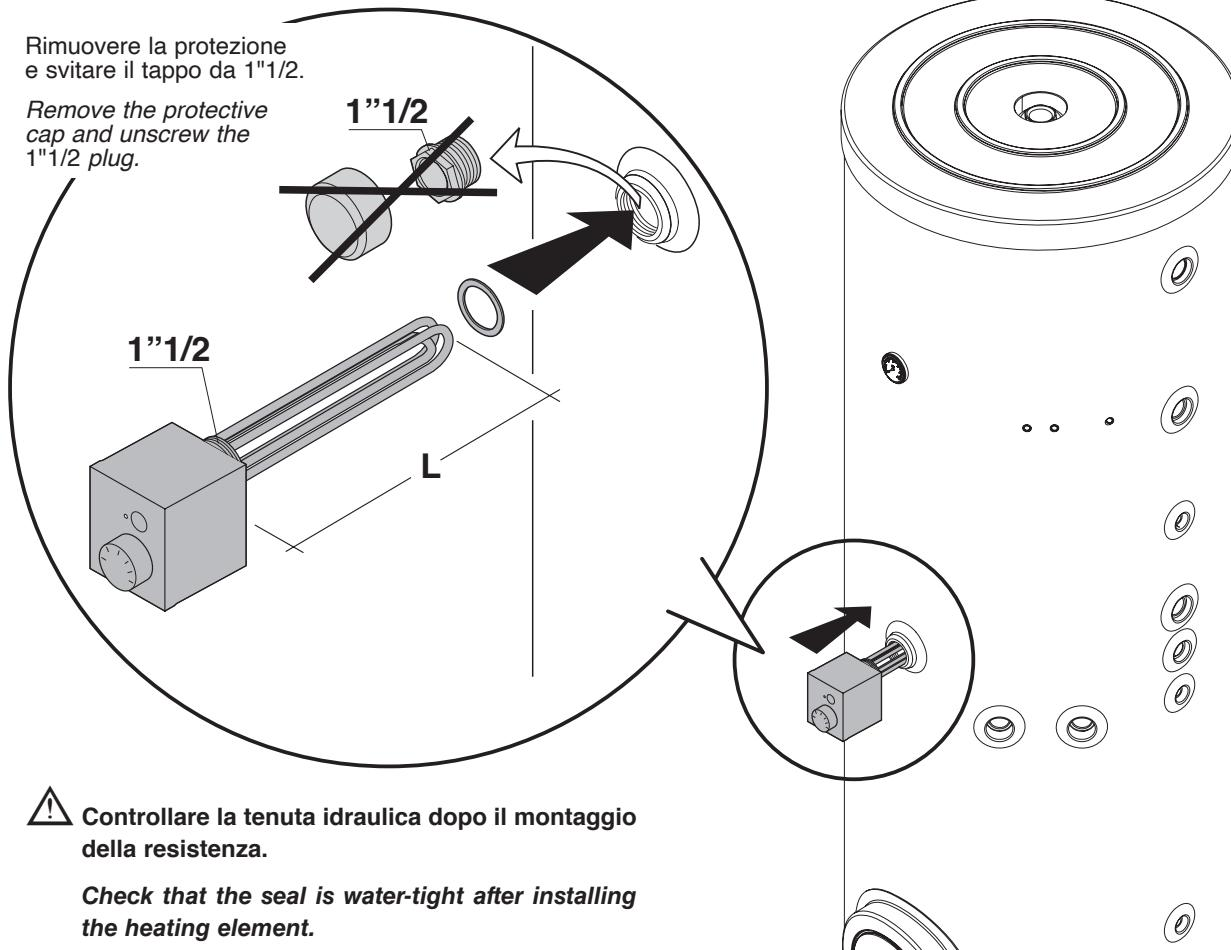
**⚠ Controllare la tenuta idraulica dopo il montaggio della resistenza.**
