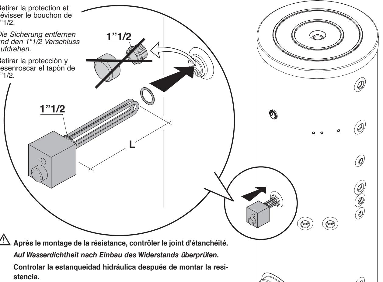
**⚠️** Après le montage de la résistance, contrôler le joint d'étanchéité.
