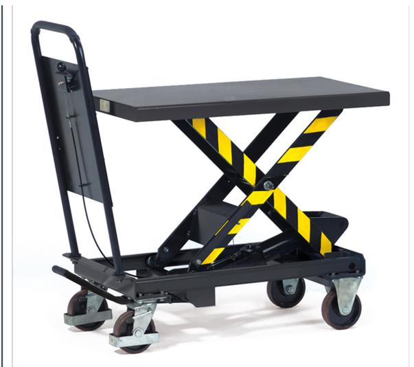
Profilstahl-/Stahlblech-Konstruktion, pulverbeschichtet anthrazitgrau RAL 7016. Kräftiger Rohrschiebebügel. Hydraulikpumpe mit verchromten Kolben. Betätigung über Fußpedal. Senkventil über Handhebel feinfühlig zu betätigen. Plattform 50 mm hoch. 2 Lenk- und 2 Bockrollen, Räder Polyurethan-Bereifung, Lenkrollen mit Feststeller. 2 Jahre Garantie
