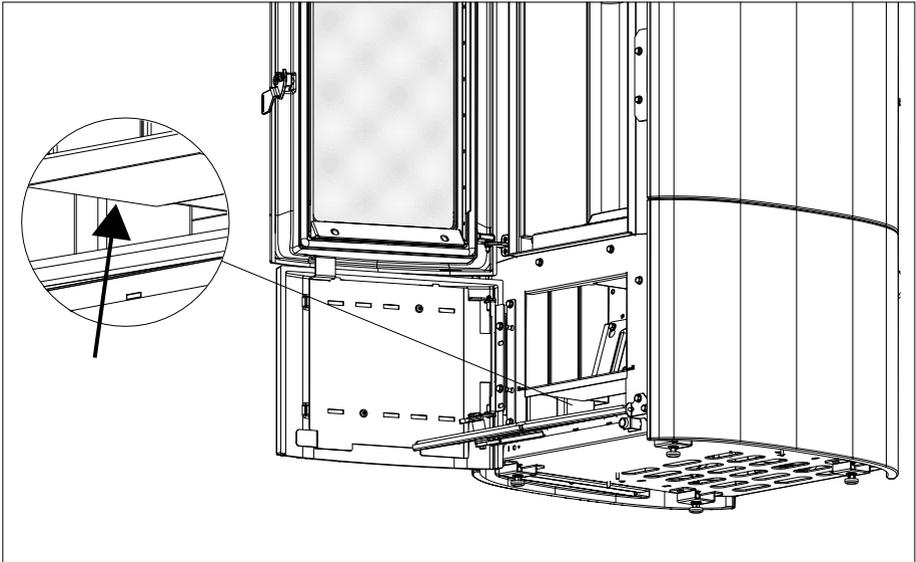
Dann das obere Teil aus Calorite „J“ herausnehmen, dazu die Brennrammertür öffnen und oben mit den Händen die Calorite-Platte „J“ nach oben anheben und nach rechts oder links neigen, um sie aus den Halterungen zu lösen, und herausnehmen.
