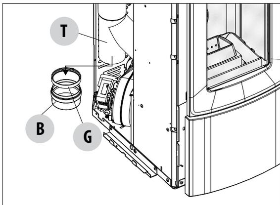
Nach dem Abnehmen der Seitenplatte die Rauchgasleitung reinigen.
