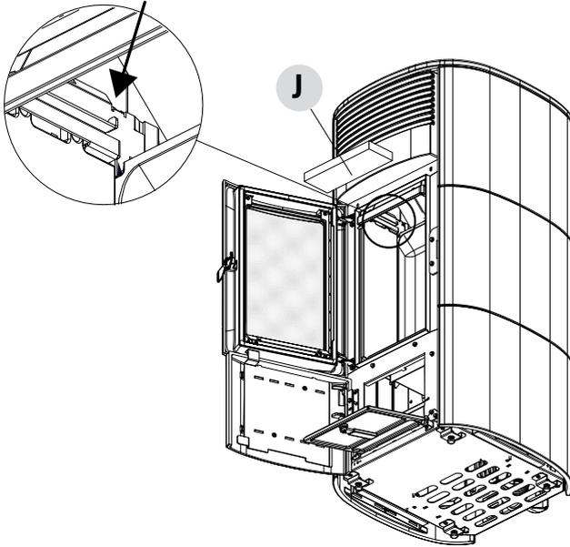
Mit der Staubsaugerdüse Asche und Staub, die sich über dem Wärmetauscher angesammelt haben, absaugen (siehe Pfeil). Anschließend auch den unteren Wärmetauscher noch einmal gründlich reinigen, ggf. die Dichtungen austauschen und alles wieder zusammenbauen.
