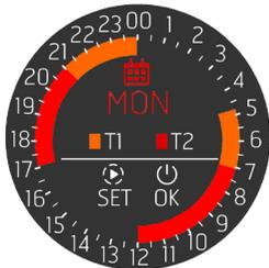
Wenn ein Tag ausgewählt wird (MONDAY), wird die Programmierung für diesen Tag aufgerufen und eine Zusammenfassung der für diesen Tag bereits vorgesehenen Programmierung angezeigt. Der Kreis verfügt über 48 Sektoren, die den 24 Stunden plus den halben Stunden entsprechen. Der Kreis hat unterschiedliche Farben, je nachdem, ob die Temperatur programmiert ist und ob Chrono aktiv ist oder nicht.
