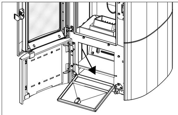
**Achtung! Nach der Reinigung nicht vergessen, den Aschenkasten „P“ wieder zu positionieren, alle Türen („I“, „R“, „F“) wieder zu schließen, die Brennschale und das Aschengitter „S“ einzufügen.**
