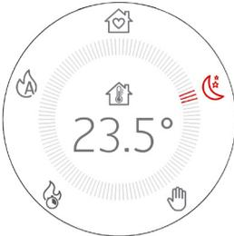
Die Tasten ermöglichen die Änderung der Temperatur und wenn die Tasten gedrückt werden, verschwinden alle Texte in der Mitte des Displays, um nur die laufende Einstellung anzuzeigen.
