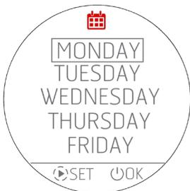
Wählen Sie in diesem Menü den Tag aus, den Sie kopieren möchten, und drücken Sie die Taste (▶)SET. Der ausgewählte Tag wird rot gefärbt und nach 1" gelangen Sie in das nächste Menü, in dem Sie gefragt werden, auf welche Tage Sie kopieren möchten.
