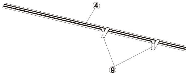
3. Die auf den Bügeln gelegten Kollektoren (9) werden mit einer Kappe (5) und Schraube (10) montiert nach vorherigem Herunterrutschen.
