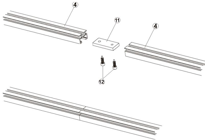
Das Verbindungsstück des Profils (11) in Aluminiumprofile (4) der Montagesätze einschieben und die Inbusschrauben anziehen (12).
