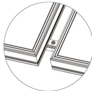
5. Seitlich werden die Kollektoren mit einer Kappe (6) und Schrauben montiert (10).
