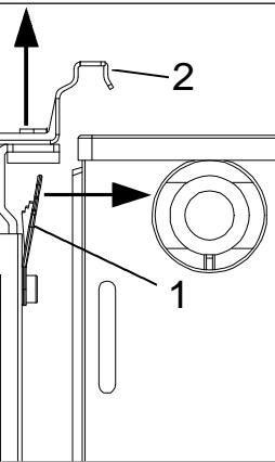
**D:** Zur Demontage des Heizkörpers Kunststoffsicherung (Pos.1) nach vorne drücken und oberen Halter (Pos.2) aus der Schiene soweit rausziehen, dass sich der Heizkörper abnehmen lässt.
