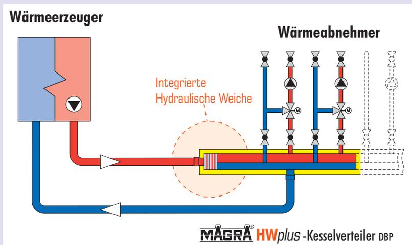
*Die Hydraulische Weiche dient der Entkopplung von Wärmeerzeugerkreis und nachgeschalteten Heizkreisen.*
