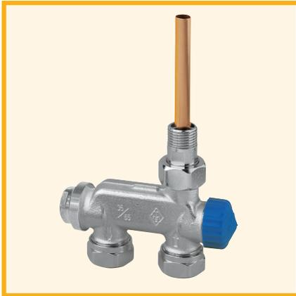
HEIMEIER E-Z Ventil aus korrosionsbeständigem Rotguss vernickelt mit Tauchrohr für Heizkörper mit unterem Einpunktanschluss. Ausführungen in Eck- und Durchgangsform jeweils für Ein- und Zweirohranlagen. Die Einrohrausführung verfügt im Auslegungsfall über einen Heizkörperanteil von 35%.
