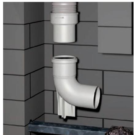
Gegenüber der Anschlussöffnung Bohrung anbringen (d=10-12mm).
