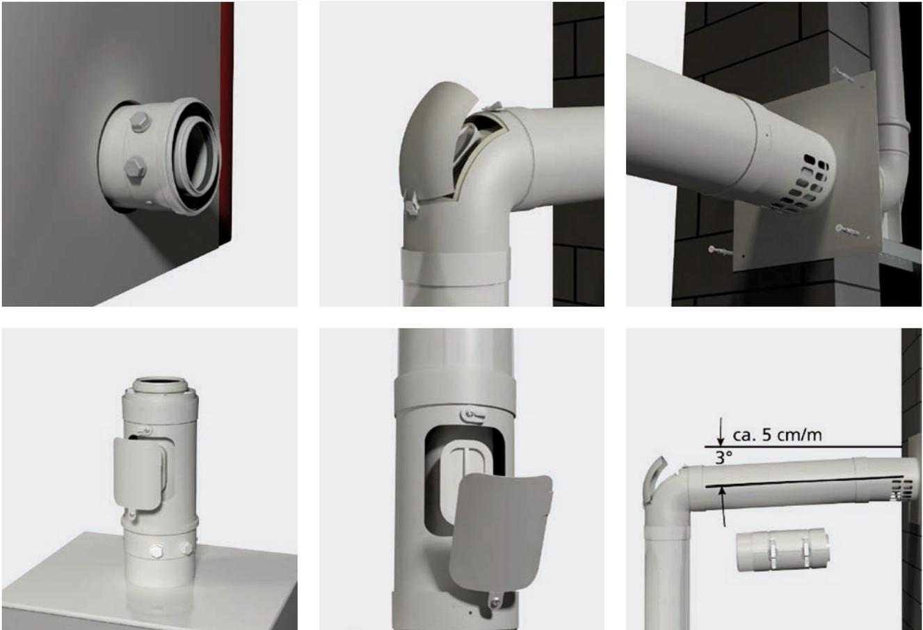
Anschlussstück am Kesselstutzen montieren. Messstück möglichst nahe am Wärmeerzeuger anbringen. Nötigenfalls Adapter zwischen Wärmeerzeuger und Messstück montieren.
