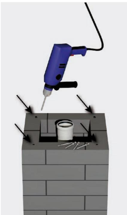
Schachtmündung vorbereiten für Montage der Schachtabdeckung. Vier Befestigungspunkte festlegen und Bohrungen für mitgelieferte Schlagdübel M6 vornehmen.
