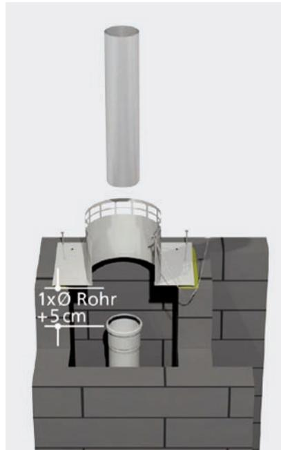
Unterteil der Schachtabdeckung montieren mittels mitgelieferter Schlagdübel. Geeignete Dichtmasse (witterungs- und UV-beständig) zwischen Schacht und Schachtabdeckung verwenden. Mündungsrohr (metallisch) durch Schachtabdeckung einschieben und in letzte Rohrmuffe einstecken. Dies muss hier mind. die Länge des Rohrdurchmessers in den Schacht hineinragen.
