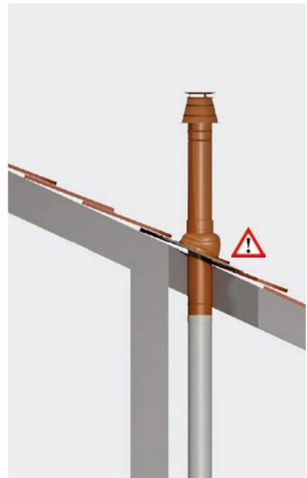
Je nach Dachüberstand ist mit einer Dachdurchführung mit Schrägdachpfanne oder Flachdachkragen zu arbeiten.
