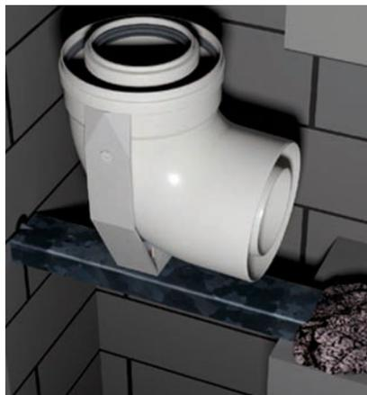
Gegenüber der Anschlussöffnung Bohrung anbringen (d=10-12mm).
