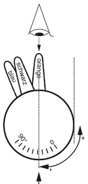
**Weniger Luft Stufe 2:** Den **orangefarbenen** Verstellhebel gegen den Uhrzeigersinn auf kleineren Öffnungswinkel stellen. Den Brenner kurz auf Stufe 1 zurückschalten (grünen Stecker ziehen). Nach erneutem Einschalten der Stufe 2 dreht der Stellmotor auf die geänderte Luftmenge.
