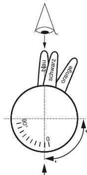
**Weniger Luft Stufe 1:** Den **blauen** Verstellhebel gegen den Uhrzeigersinn auf kleineren Öffnungswinkel stellen. Bei laufendem Brenner dreht der Stellmotor selbsttätig nach.
