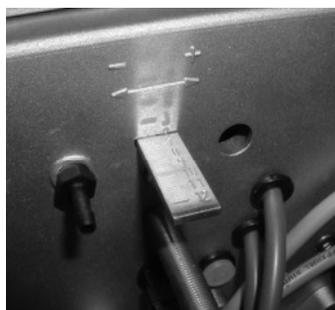
Eine Verstellung des Düsenstockes durch **Links-drehen** der Stell-schraube in Richtung **größerer Skalenwerte, erhöht die Luftmenge** und **verringert damit den CO<sub>2</sub> - Anteil** im Abgas und verringert den Mischdruck.
