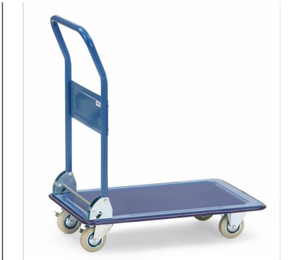
Ganzstahlwagen mit Plattform aus Stahlblech gepresst, pulverbeschichtet blau RAL 5007. Mit aufgeklebtem Antirutschbelag und umlaufender Schutzleiste. Rohrschiebebügel klappbar, mit breiter Querstrebe. Klappgelenk glanzverzinkt. 2 Lenk- und 2 Bockrollen, Vollgummibereifung, Feststeller an den Lenkrollen, gemäß der Europäischen Norm EN 1757-3. Zerlegte Anlieferung.
