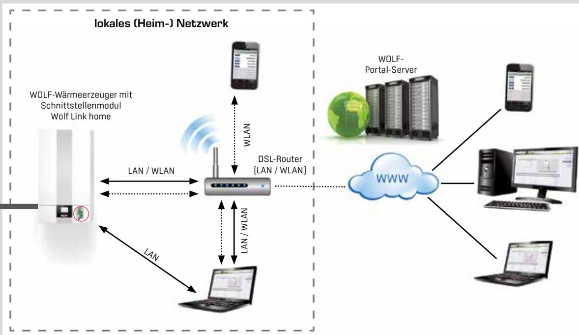
Wolf Link home ermöglicht die Einbindung von WOLF-Wärmeerzeugern in das Smart Home System von „wibutler“. In Kombination mit den Raumfühlern und Raumthermostaten des Smart Home Systemanbieters ermöglicht das Set eine bedarfsgeführte Einzelraumregelung über die Vorlaufemperaturadaption anhand des tatsächlichen Wärmebedarfs der Bewohner und der Gegebenheiten des Hauses. Gleichzeitig ermöglicht das Smarthome-Set dem Fachhandwerker über das WOLF-Internet-Portal Fernwartung und Diagnose.
