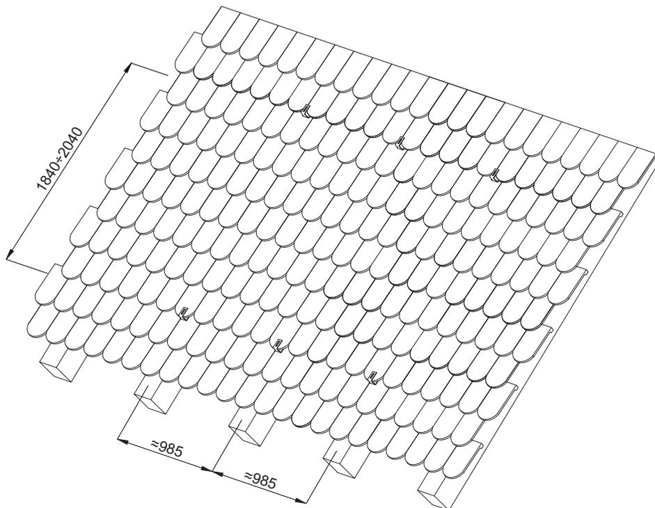
Die Haken anbringen und dan die Dachziegel wider einsetzen.
