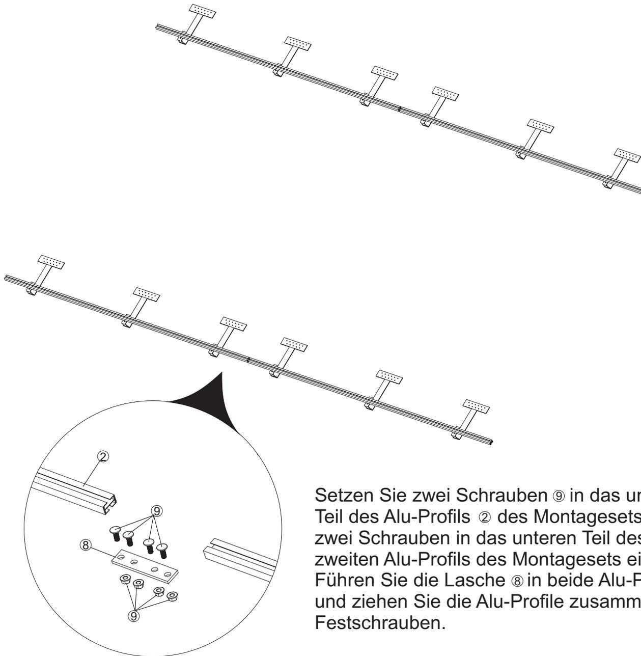
Setzen Sie zwei Schrauben ⑨ in das unteren Teil des Alu-Profiles ② des Montagesets und zwei Schrauben in das unteren Teil des zweiten Alu-Profiles des Montagesets ein. Führen Sie die Lasche ⑧ in beide Alu-Profile und ziehen Sie die Alu-Profile zusammen dan Festschrauben.
