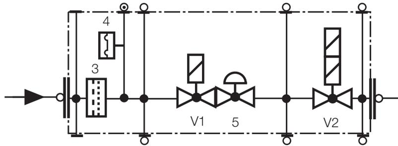
Anbau des Ventilprüfsystem VPS 504 möglich
