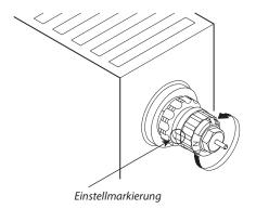
Bei den Einbauventilen Typ RA-N und RA-U lassen sich die dimensionierten Einstellwerte ohne Spezialwerkzeug einfach und exakt einstellen (Werkseinstellung: N):
