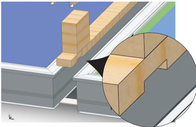
Am mittleren Holz die Ausfräsung für die Verbindungs-Platten herstellen.
