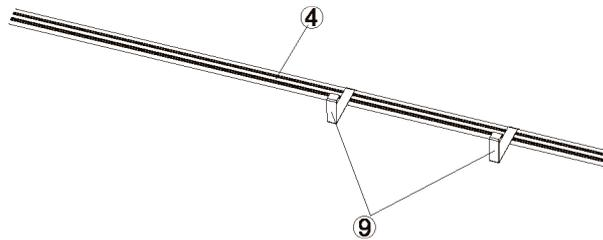
3. Die auf den Bügeln gelegten Kollektoren (9) werden mit einer Kappe (5) und Schraube (10) montiert nach vorherigem Herunterrutschen.
