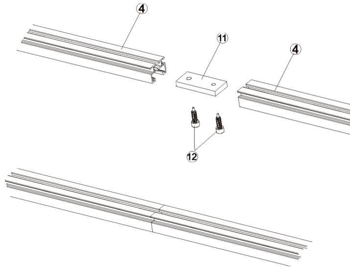
Das Verbindungsstück des Profils (11) in Aluminiumprofile (4) der Montagesätze einschieben und die Inbusschrauben anziehen (12).
