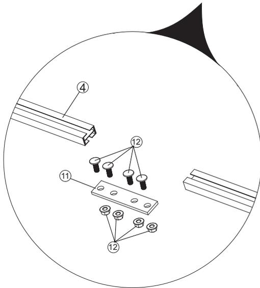
Setzen Sie zwei Schrauben ⑫ in das unteren Teil des Alu-Profils ④ des Montagesets und zwei Schrauben in das unteren Teil des zweiten Alu-Profils des Montagesets ein. Führen Sie die Lasche ⑪ in beide Alu-Profile und ziehen Sie die Alu-Profile zusammen dan Festschrauben.
