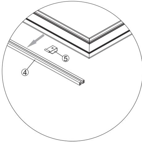
3. Setzen Sie die Aufhänger an dem unteren Alu-Profil um den Kollektor von beiden Seiten zur Stützen.
