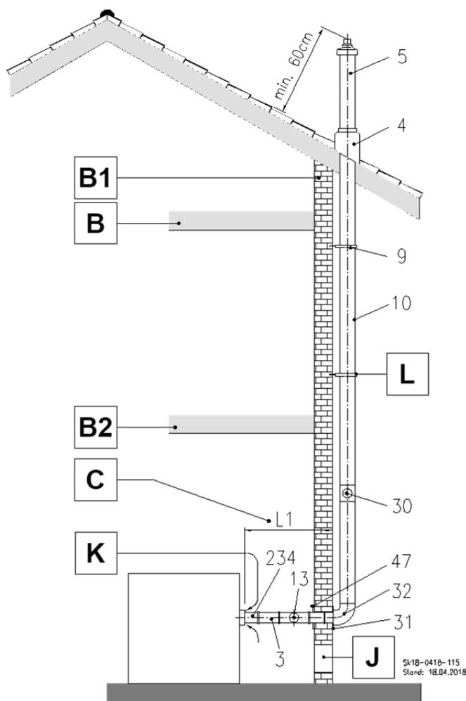
Abb. 42: B<sub>23</sub> Abgasrohr an der Außenwand
