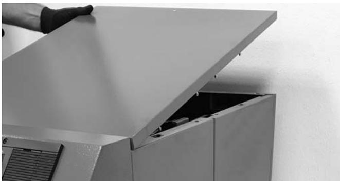
Abb. 79: Demontage der oberen Verkleidung
