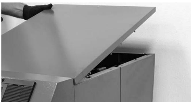
Abb. 26: Demontage des Verkleidungsdeckels
