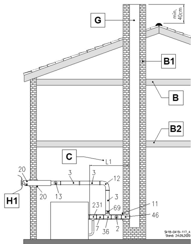
Abb. 50: C<sub>83x</sub> Anschluss an einen feuchte-unempfindlichen Abgasschornstein und Zuluft durch die Außenwand
