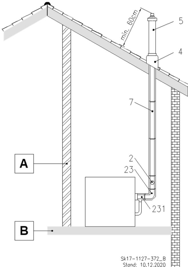
Abb. 47: C<sub>33x</sub> Dachheizzentrale mit der Durchführung senkrecht durch ein Schrägdach
