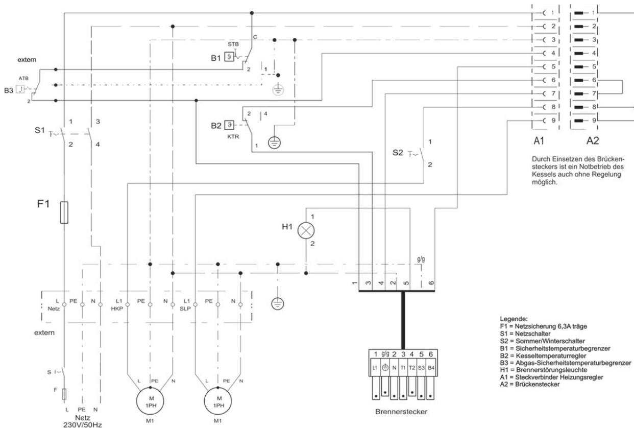
Abb. 36: Kessel-Grundschriftfeld ohne Regler: Elektrische Anschlüsse und Stromlaufplan
