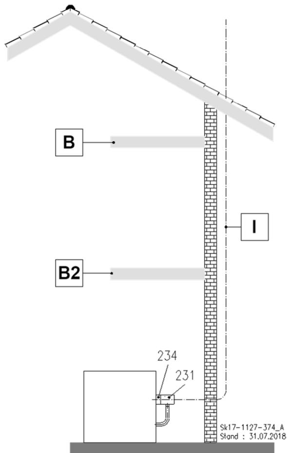
Abb. 49: C<sub>63x</sub> Für Anschluss an eine nicht mit der Gasfeuerstätte geprüfte Verbrennungsluftzuführung und Abgasabführung
