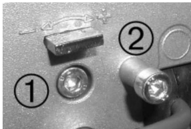
Abb. 75: Druckmessnippel (2)
