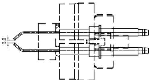
Abb. 95: Der Elektrodenabstand ist 3,0 mm
