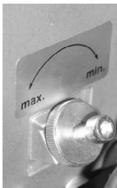
Durch die Verstellung der Luftklappe wird die Verbrennungsluft an die Ölmenge (Leistung) angepasst. Der Luftüberschuss - gemessen als CO<sub>2</sub>- oder O<sub>2</sub>-Anteil in den Verbrennungsabgasen - wird über die Luftklappe mit einem geeigneten Emissionsmessgerät an die Vorgaben in der Grundeinstellwerte angepasst.
