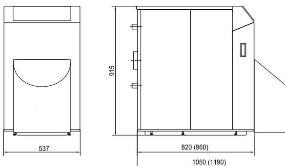
Abb. 2: Abmessungen (in Klammern Typ 30 u. 40)
