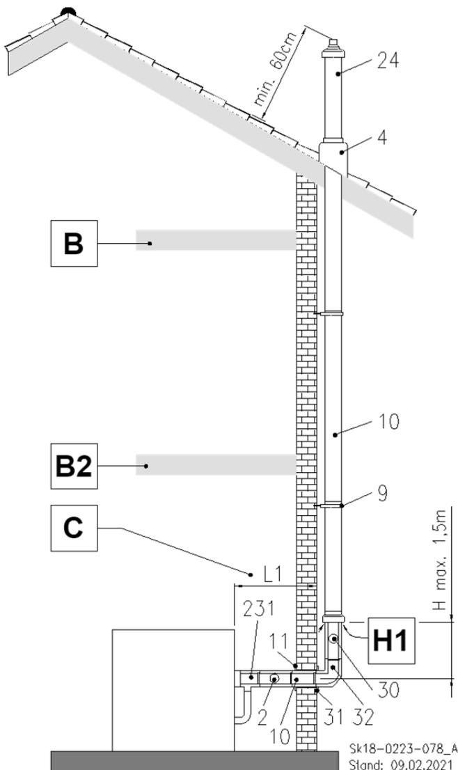
Abb. 48: C<sub>53x</sub> Außenwandführung LAS
