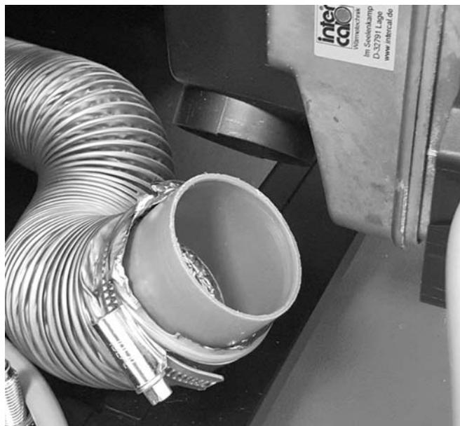
Abb. 13: Zuluftschlauch mit 50 mm Anschluss-Stück
