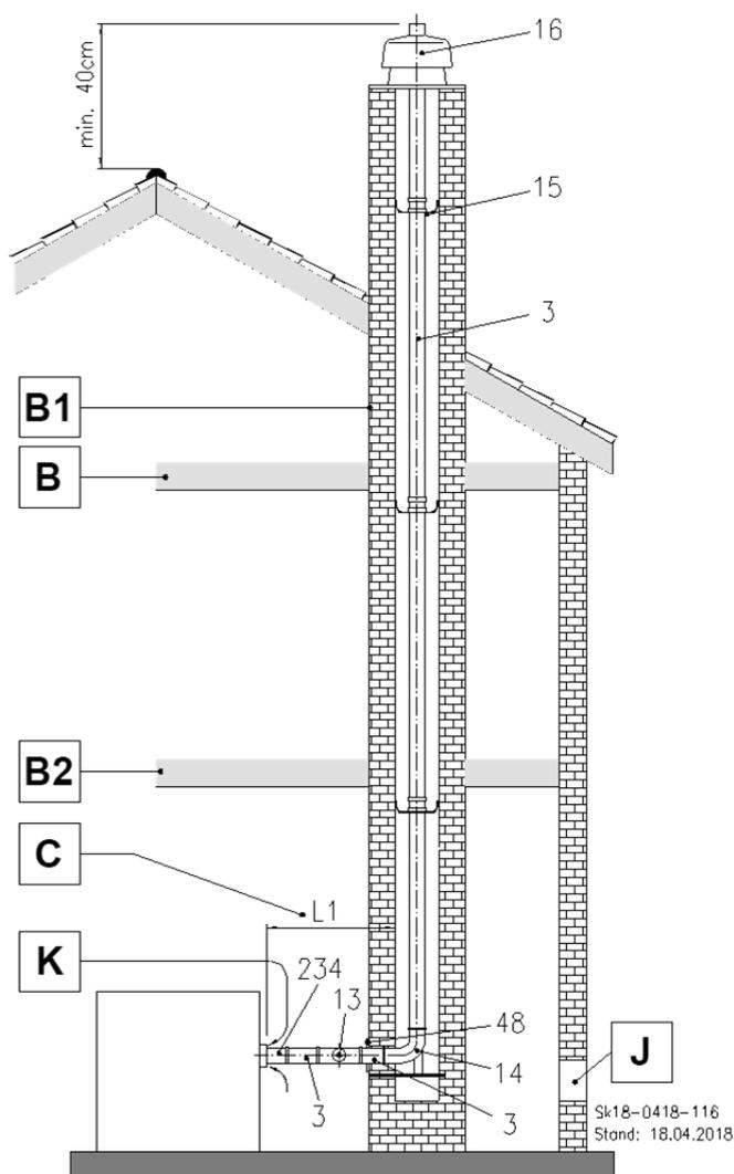
Abb. 43: B<sub>23</sub> Abgasrohr im Schornstein
