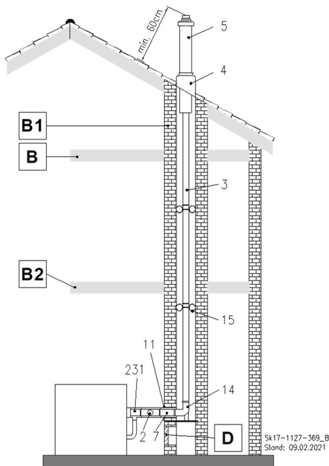
Abb. 51: C<sub>93x</sub> Luft-Abgas-System im Schacht und Luft-Abgas-Rohrsystem mit Dachdurchführung
