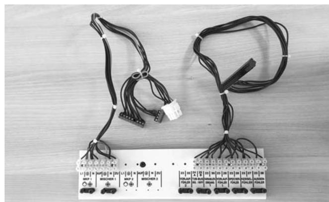
Abb. 30: Regler-Kabelbaum mit Klemmen und Steckverbinder zum Kesselschaltfeld.
