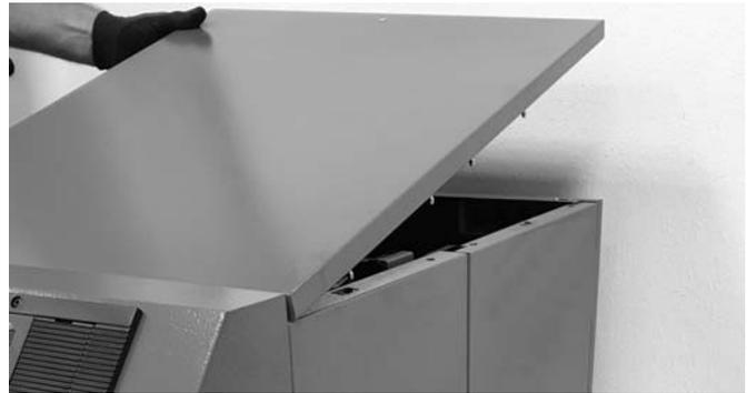
Abb. 4: Demontage der oberen Verkleidung
