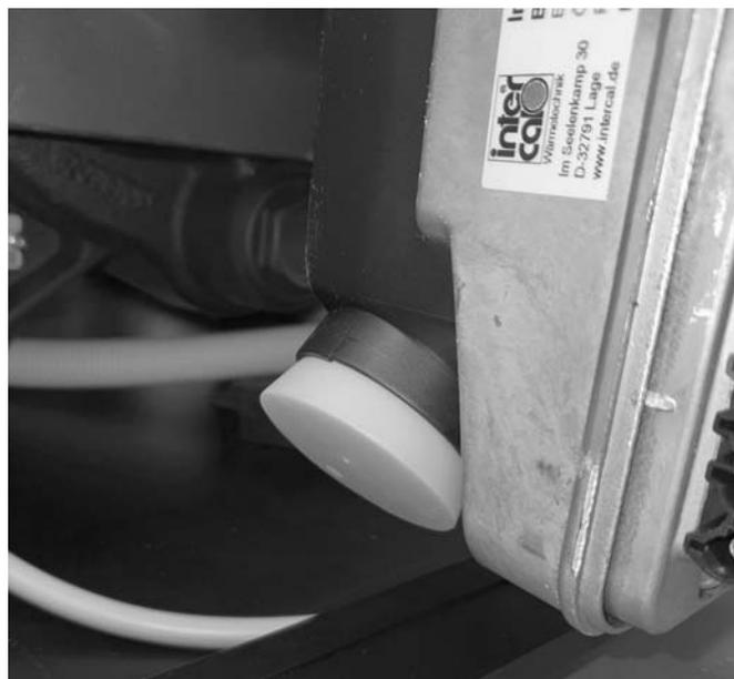
Abb. 8: Zuluftstopfen im Ansaugschalldämpfer
