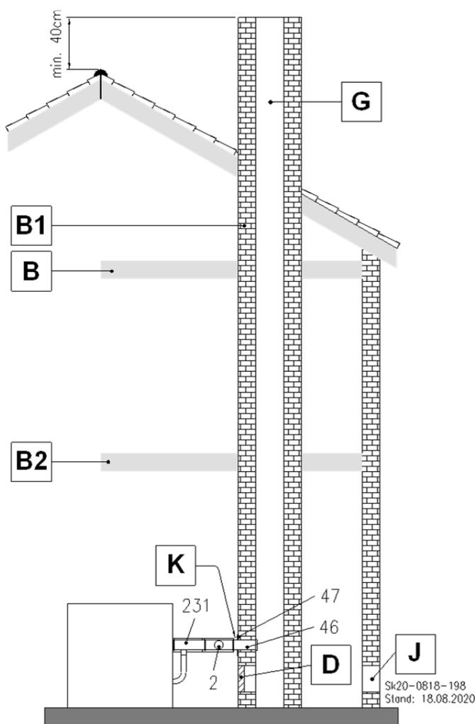
Abb. 44: B<sub>33</sub> Abgasrohr endet im feuchteunempfindlichen Schornstein
