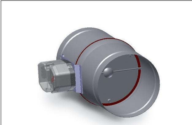
Diese Bypassklappe ist so ausgelegt, dass sie bei Stromausfall oder Abschalten des Ventilators, selbsttätig durch einen Federrücklaufmotor öffnet und somit eine freie Abströmung ermöglicht.
