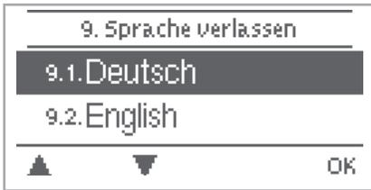
Über das Menü "9. Sprache" kann die Sprache der Menüführung gewählt werden. Bei der ersten Inbetriebnahme erfolgt die Abfrage automatisch. Die wählbaren Sprachen können sich je nach Geräteausführung unterscheiden! Die Sprachwahl ist nicht in jeder Geräteausführung vorhanden!
