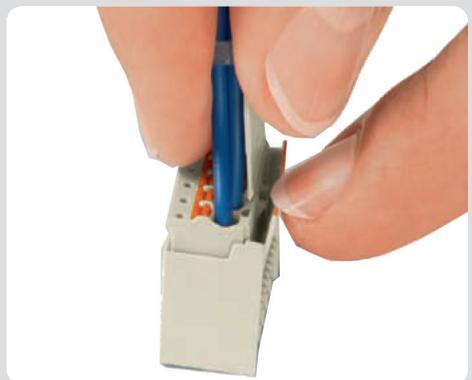
Zum Entfernen der Federleisten die Rastlasche auf der Unterseite der Stiftleiste vorsichtig wegbiegen (Achtung: Bruchgefahr!)
