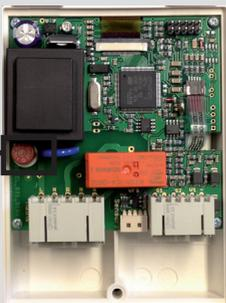
Hat der Regler trotz eingeschalteter Netzspannung keine Funktion und Anzeige mehr, so ist es möglich, dass die interne Gerätesicherung defekt ist. Zum Austausch der Gerätesicherung, das Gerät öffnen, alte Sicherung entfernen und überprüfen. Die defekte Sicherung wechseln, externe Fehlerquelle (wie z.B. Pumpe) finden und austauschen. Anschließend erst den Regler wieder in Betrieb nehmen und die Funktion der Schaltausgänge im Manuellbetrieb wie unter 3.2. beschrieben überprüfen.
