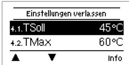
Im Menü "4. Einstellungen" werden die für die Regel-funktion nötigen Grundeinstellungen vorgenommen. Alle einstellbaren Parameter werden im Display kurz erklärt, zusätzlich wird der Einstellbereich und in Klammern der voreingestellte Wert angegeben.
