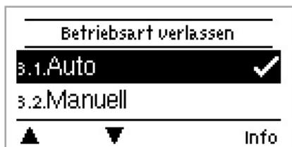
Im Menü "3. Betriebsart" kann der Regler neben dem Automatikbetrieb auch ausgeschaltet oder in einen manuellen Betriebsmodus versetzt werden.
