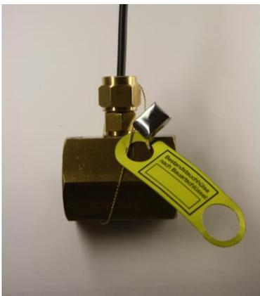
Beim Einbau der Temperatursensoren in Bestandstauchhülsen muss eine Tauchhülsenduldung vorliegen. In den folgenden Tabellen sind alle Tauchhülsen, für die eine Duldung für Engelmann-Zähler vorliegt, aufgeführt. Alle anderen, hier nicht aufgeführten Tauchhülsen dürfen nicht bedient werden.
