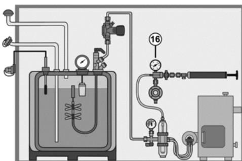
Czas trwania kontroli zgodnie z „Regulacjami technicznymi dla instalacji olejowych” (TRÖI), rozdział 4.10.4.2. „Kontrola szczelności z podciśnieniem” wynosi:
