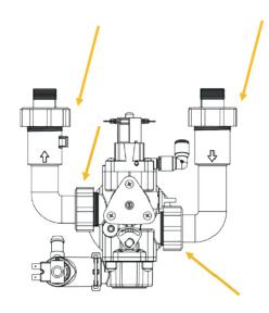
Es sollten generell alle wasserführende Anschlusselemente auf Leckage überprüft werden!
