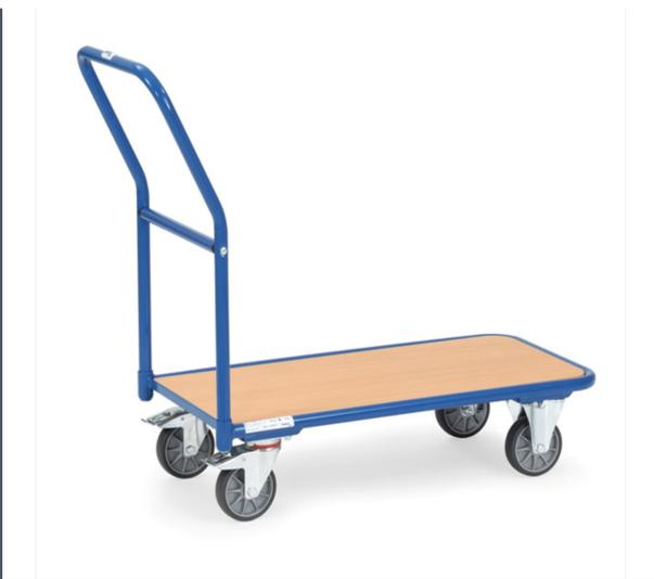
Stahlrohr, Schweißkonstruktion, pulverbeschichtet, brillantblau RAL 5007. Plattform Holzwerkstoffplatte, Oberfläche Buchendekor. 2 Lenk- und 2 Bockrollen, TPE-Bereifung, Naben mit Rillenkugellager. Feststeller an den Lenkrollen, gemäß der Europäischen Norm EN 1757-3 (Sicherheit von Plattformwagen).
