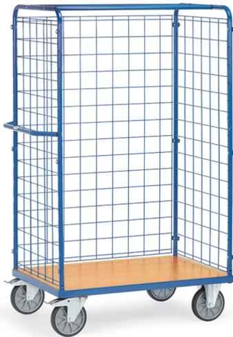
Baukasten-System, Stahlrohr und Profilstahl geschweißt, pulverbeschichtet blau RAL 5007, Schraubkonstruktion. Stirnwände und eine Längswand geschlossen mit Drahtgitter 100 x 100 x 5 mm. Plattform Holzwerkstoffplatte, Oberfläche Buchendekor. Beräderung: 2 Lenk- und 2 Bockrollen, TPE-Bereifung, Naben mit Rillenkugellager. Feststeller an den Lenkrollen, gemäß der europäischen Norm EN 1757-3 (Sicherheit von Plattformwagen).
