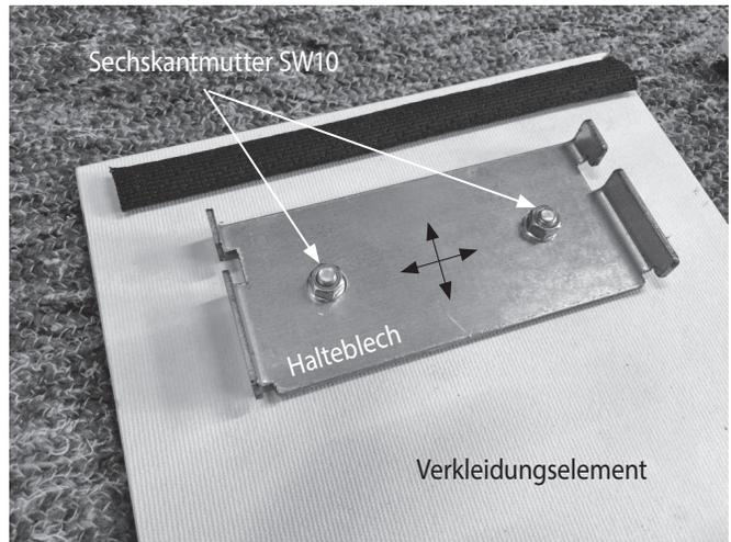
Nachfolgend wird stellvertretend die Montage der **unteren Seitenverkleidung (34)** beschrieben. Alle weiteren Verkleidungselemente werden auf die gleiche Weise in den Gerätekörper eingehangen.
