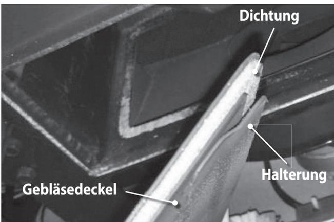
Zum Entfernen der bei der Reinigung gelösten und herabgefallenen Ablagerungen demontieren Sie den **Abgasventilator (28)**.
