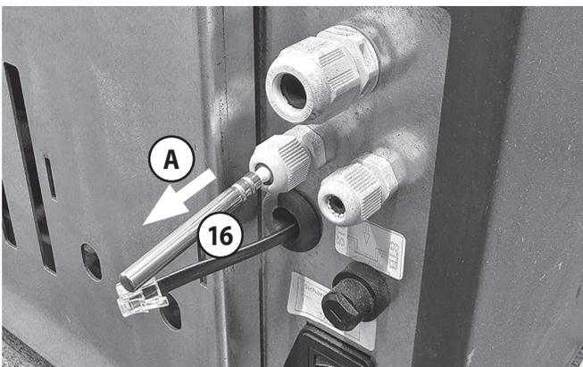
Es kann unter Umständen auch notwendig sein, dass der **Raumtemperaturfühler (16)** noch weiter aus dem Gerät herausgezogen werden muss (**B**).
