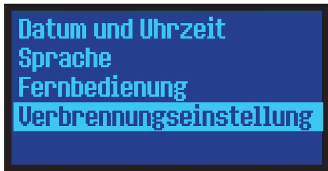
Für die optimale Anpassung des Gerätes an den zum Anschluss vorgesehenen Schornstein kann hier die Verbrennung in 4 Stufen eingestellt und die Einstellung gespeichert werden.
