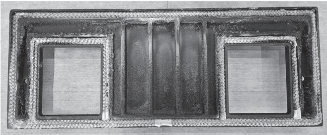
Bei abgenommenen Brennraumdeckel werden die Heizgaszüge sichtbar und leicht zugänglich.
