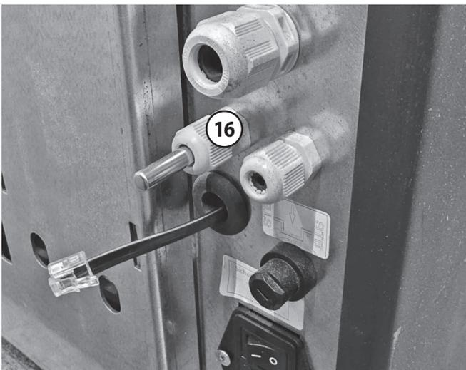
Für realistische Messwerte ist der **Raumtemperaturfühler (16)** zumindest soweit aus der Gerätedurchführung zu ziehen, bis er komplett sichtbar wird (**A**).
