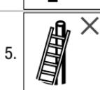
Prislove merdevine nasloniti na ravne, čvrste površine i obezbediti pre korišćenja, npr. vezivanjem ili postavljanjem pogodne opreme za obezbeđenje stabilnosti.
