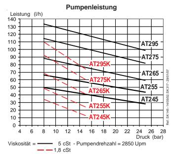
In den dargestellten Kurven ist bereits eine Abnützung des Getriebes berücksichtigt. Damit der optimale Betrieb des (NO) Magnetventils (schaltet Niederdruck/Hochdruck) gewährleistet ist, ist bei der Wahl der
