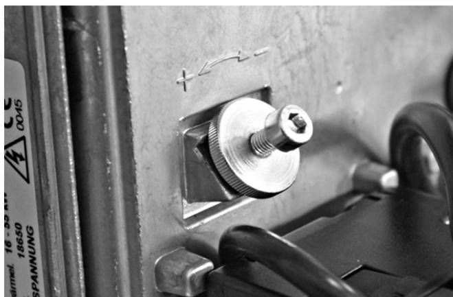
Abb. 8: Verstellerschraube der Luftklappe
