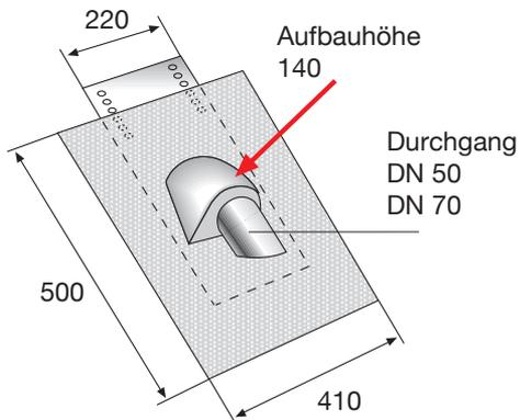
FLECK Solarflex Universaldurchgang DN 50 / DN 70.
