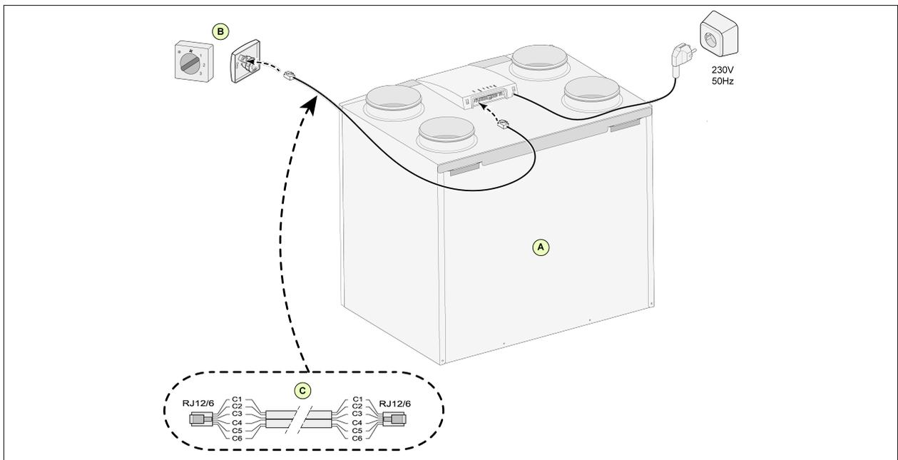
A = CWL Gerät (Als Beispiel wird eine CWL 4-0 Einheit dargestellt).
