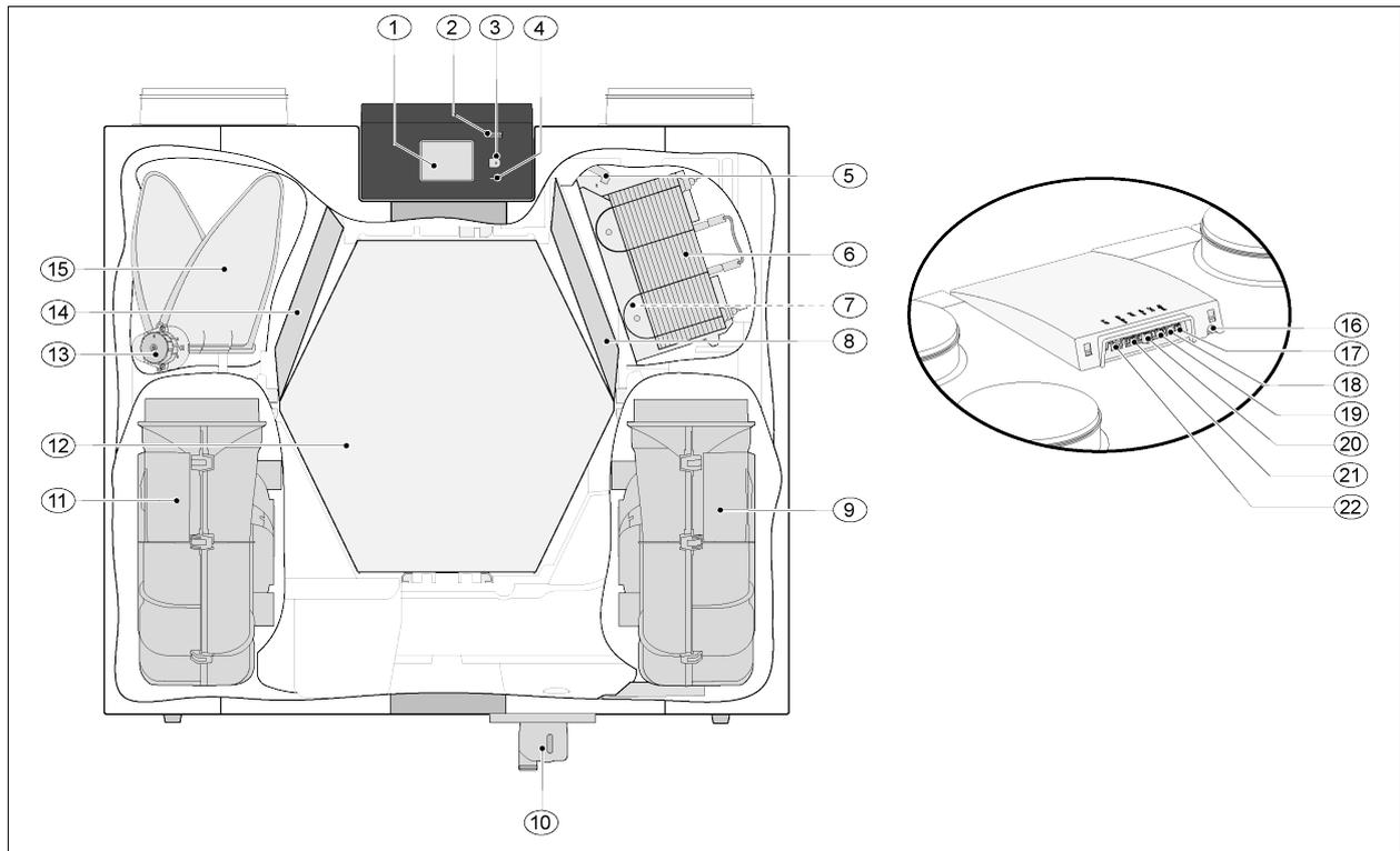
Das oben gezeigte Gerät ist eine Linksausführung; bei einer Rechtsausführung sind Vorheizregister, Bypassklappe und Siphonanschluss gespiegelt montiert!
