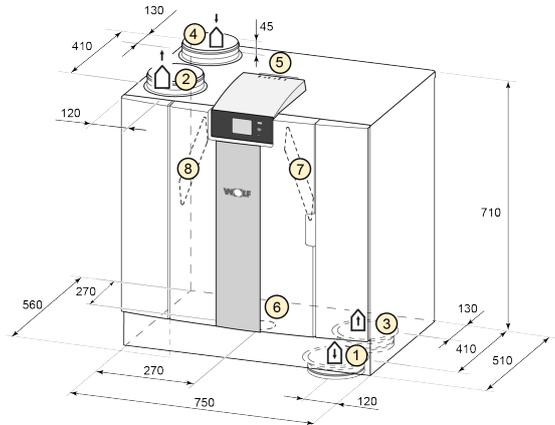
Alle Abmessungen sind in mm angegeben. Der Durchmesser sämtlicher Bundringe beträgt 180 mm.
