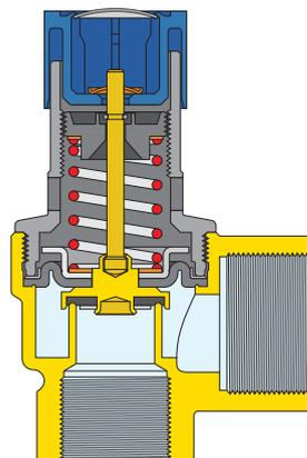
Für geschlossene Warmwasserbereitungsanlagen nach DIN 4753 Teil 1, bauteilgeprüft gem. SR-Blatt 2. Das Membran-Sicherheitsventil Typ 531 dient zur Absicherung von unter Druck stehenden Flüssigkeitssystemen gegen Drucküberschreitung. Es wird in erster Linie zum Absichern von geschlossenen Warmwasserbereitern verwendet.
