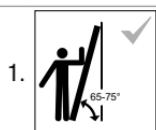
Лестница должна устанавливаться в правильном монтажном положении с соблюдением угла установки (угол наклона от 65 до 75°), ступени и проступи должны располагаться горизонтально.
