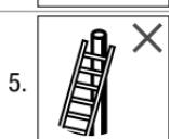
Приставные лестницы должны опираться только на плоское, прочное основание и перед использованием фиксироваться соответствующим образом, например, привязкой к пригодным для этого предметам для обеспечения необходимой устойчивости.
