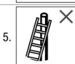
5. Ankelstegar skall lutas mot fasta ytor och säkras innan användningen t.ex. genom att bindas fast eller montering av anordningar som säkrar stårds-äkerheten.
