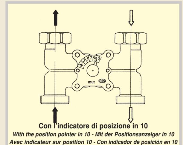
La valvola deve essere installata nel circuito idraulico rispettando il senso del flusso specificato sull'esempio di applicazione. La necessità di avere l'inversione di flusso in una via, comporta l'inversione in tutte le altre vie.
