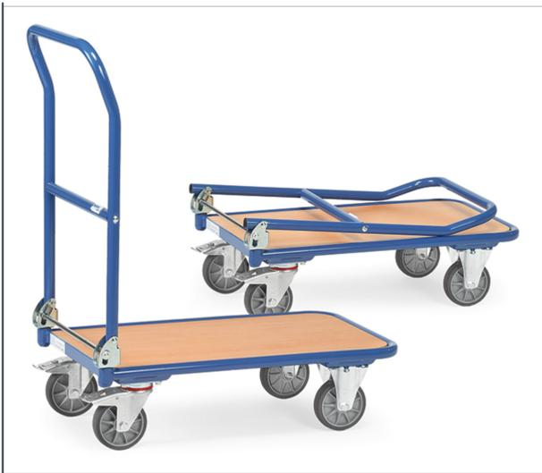
Klappwagen aus Stahlrohr, pulverbeschichtet brillantblau RAL 5007. Ladefläche aus Holzwerkstoffplatte, Oberfläche Buchendekor. Schiebebügel auf Plattform klappbar. 2 Lenk- und 2 Bockrollen, TPE-Bereifung (spurlos), Naben mit Rillenkugellager. Feststeller an den Lenkrollen, gemäß der Europäischen Norm EN 1757-3 (Sicherheit von Plattformwagen).
