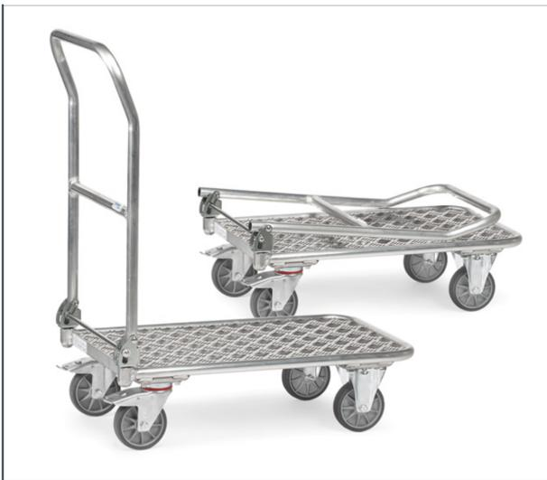
Alurohrwagen mit Aluplattform, Schiebebügel auf Plattform klappbar. 2 Lenk- und 2 Bockrollen, TPE-Bereifung, Naben mit Rillenkugellager. Feststeller an den Lenkrollen, gemäß der Europäischen Norm EN 1757-3 (Sicherheit von Plattformwagen).
