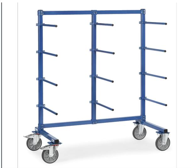
Rahmen aus stabilem Quadratrohr. Rollen-Traversen, Pfosten und Streben durch kräftige Schraubchellen verbunden. Tragarme aus Stahlrohr 27 mm Ø mit Schraubchellen. 12 Tragarme einseitig. Nutzlänge 600 mm, Tragkraft pro Etage 80 kg. Pulverbeschichtet blau RAL 5007. 2 Lenk- und 2 Bockrollen, TPE-Bereifung, Naben mit Rillenkugellager. Feststeller an den Lenkrollen, gemäß der Europäischen Norm EN 1757-3 (Sicherheit von Plattformwagen).
