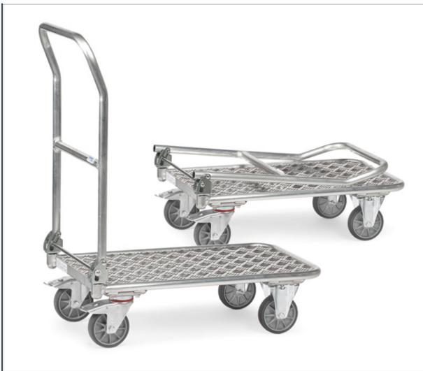
Alu-Rohrwagen mit Aluplattform, Schiebebügel auf Plattform klappbar. 2 Lenk- und 2 Bockrollen, TPE-Bereifung (spurlos), Naben mit Rillenkugellager. Feststeller an den Lenkrollen, gemäß der Europäischen Norm EN 1757-3 (Sicherheit von Plattformwagen).
