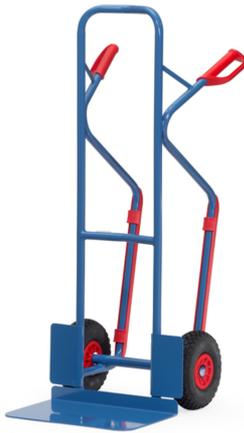
Stahlrohr-Stapelkarre mit Stahlblechschaufel, stabile Schweißkonstruktion, pulverbeschichtet blau RAL 5007. Sicherheitsgriffe. Stahlblechschaufel anschraubbar und dadurch austauschbar. Mit auswechselbaren Kunststoff-Gleitkufen. Räder mit pannensicherer PU-Bereifung, auf Kunststoff-Felgen, Naben mit Rollenlagerung. Bügel oben und Querstreben durchgebogen. Für den sicheren Transport von runden Gütern, wie Rollen, Kannen, Eimern usw. Zerlegte Anlieferung.
