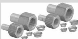
Alternativ können die Kältemittelleitungen auch mit den Anschluss-Set Euro Bördeladapter zum Hartlöten an Kältemittelleitungen (Spülung der Leitungen mit Stickstoff erforderlich) aus dem Wolf-Zubehör angeschlossen werden.
