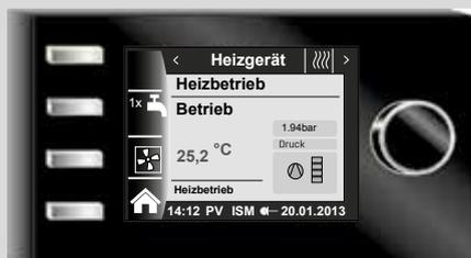
Das BM-2 (Bedienmodul) kommuniziert über eBus mit allen angeschlossenen Erweiterungsmodulen und mit der Split-Luft/Wasser-Wärmepumpe.
