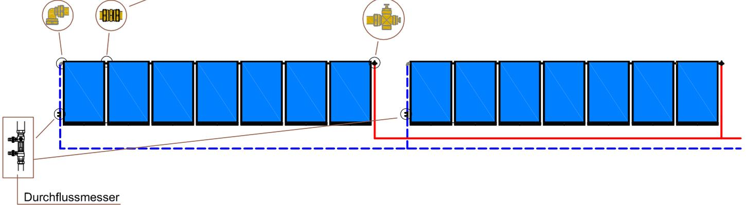
Kombinierte Serielle Verbindung in mehreren Reihen (maximal 7 Kollektoren in der Batterie - empfohlen 5) - Tichelmann
