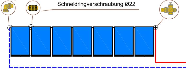
Kombinierte Serielle Verbindung in einer Reihe (maximal 7 Kollektoren in der Batterie - empfohlen 5)
