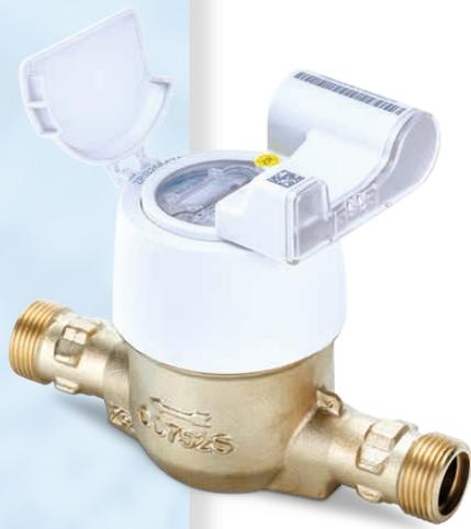
Das **EDC-Kommunikationsmodul** (Electronic data capture module) dient der elektronischen, rückwirkungsfreien Abtastung aller mit Modulatorscheibe ausgestatteten ZENNER-Wasserzähler. Es ermöglicht die sichere Fernauslesung bzw. die Einbindung von Wasserzählern in moderne Smart-Metering-Messsysteme.
